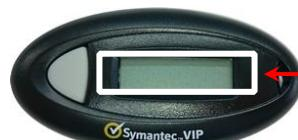
数字が残量を表します。「bAtt 09」はバッテリー残量9%を表します。バッテリー残量は「bAtt 01」まで1%刻みで表示します。
